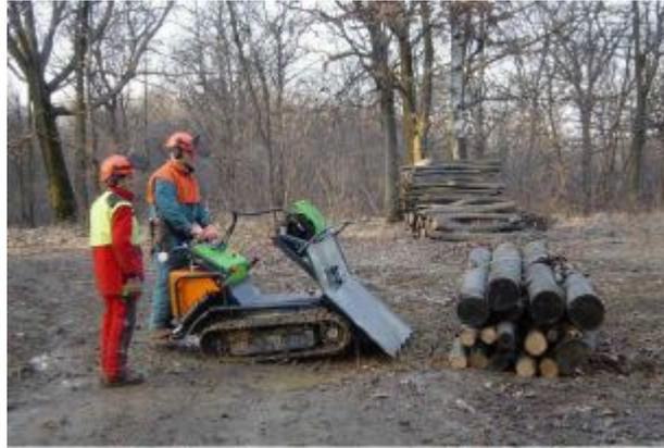
Utilizzo di carriola semovente con verricello a scudo nell'esbosco di legname di corte dimensioni
