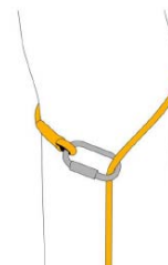
Fig. 2 - Strozzo diretto della fune
