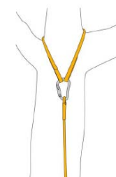
Fig. 5 - Ancoraggio della fune con dispositivo passante
